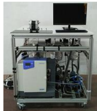
Imagen 12: Banco de ensayos PEM de 500W
