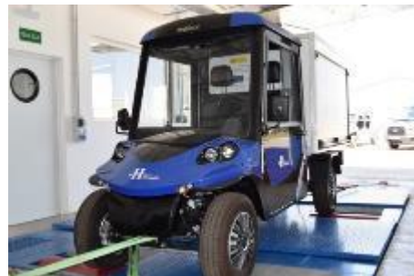
Imagen 16: Vehículo de pila de combustible desarrollado por el CNH2
