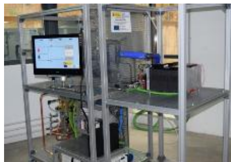
Imagen 17: Banco de ensayos para sistemas de Pilas de Combustible de potencia comprendida entre 10-30 kW
