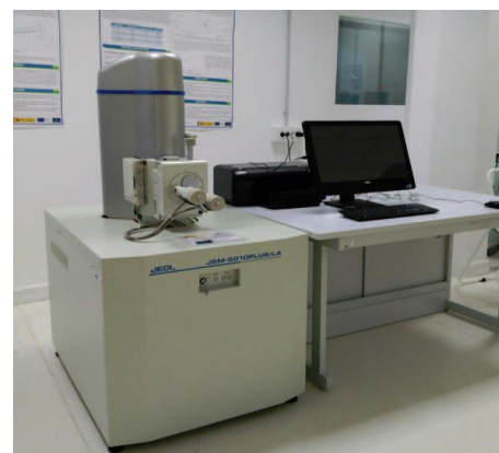
Imagen 11: Microscopio electrónico de barrido (SEM-EDS).
