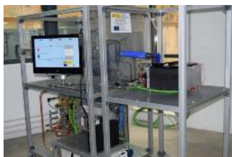
Imagen 8. Banco de ensayos para sistemas de Pilas de Combustible de potencia comprendida entre 10-30 kw.
