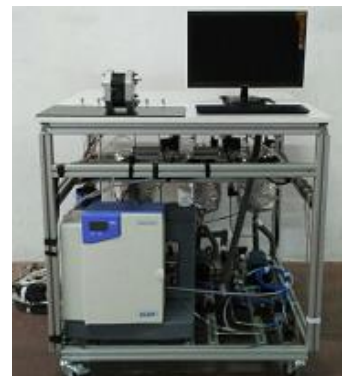
Imagen 3. Banco de ensayos PEM de 500W.
