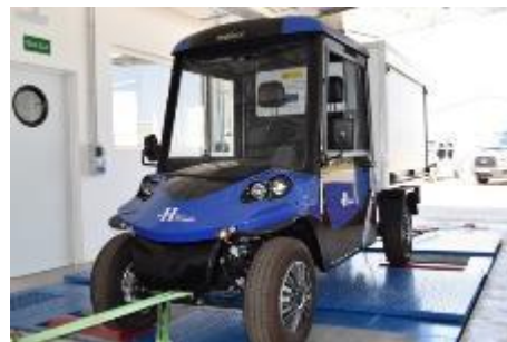
Imagen 7. Vehículo de pila de combustible desarrollado por el CNH2.
