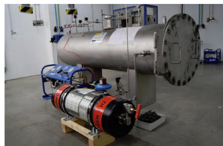
Imagen 10. Banco de ensayos de permeación de H 2 .
